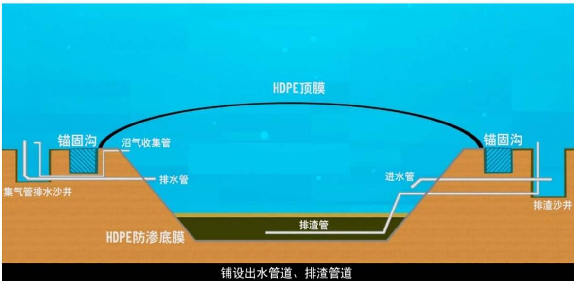
图 6-2 盖泻湖（黑膜）沼气池结构示意图
